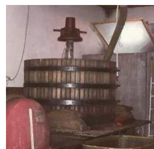
■伝統式垂直圧搾機 100年以上前に造られたもので、現在も使用している。
